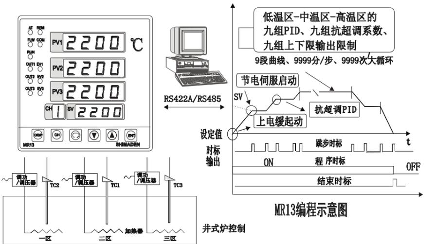
超过三温区的多区控制,可以利用MR13的模拟发送功能,级连的从表[1-24B]置第一回路遥控输入ON,其余回路跟踪第一路的设定值。
