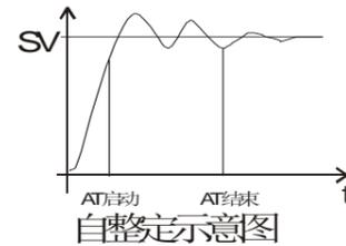
在[0-8]比例带窗口, P=0.1~999.9%测量范围或 OFF(位式);[0-10]积分时间窗口, I=1~6000 秒或 OFF;[0-11]微分时间窗口, D=0~3600 秒或 OFF。按 CH 键,可依次更改回路号,检查及手动设置相应 CH2, CH3 的 PID 值。
