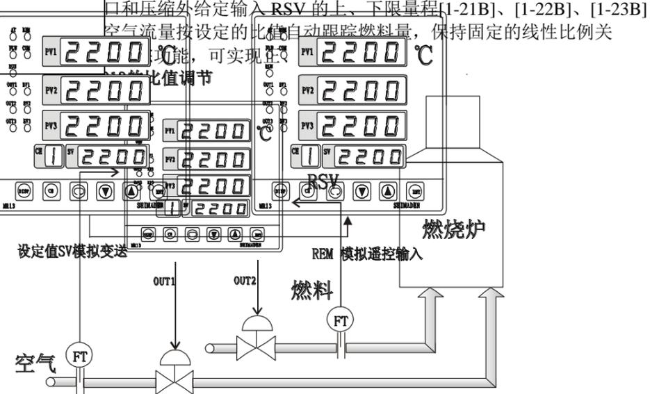
5. MR13 独立组成的串级调节系统用于大滞后系统, 如反应釜等。反应釜内温度响应速度慢, 而加热套的温度响应速度快。将 MR13 的第三回路的调节输出变送至第一回路的 SV 输入 (将模拟遥控输入 REM 外给定方式指定给第一回路的输入), 调节输出选正作用, 第二回路的 PV2 和 SV2 分别跟踪第一回路的 PV1 和 SV1, 输出选反作用。
