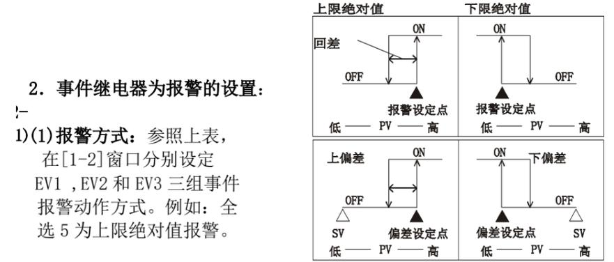
(2)报警回差:(报警动作灵敏度)[1-3]窗口:如报警示意图所示,进/出报警动作值不一致,其差值称为回差,用于避免继电器频繁动作和干扰。MR13的回差值可设,例如,EIDF设为24,则1200℃的回差值24℃。
